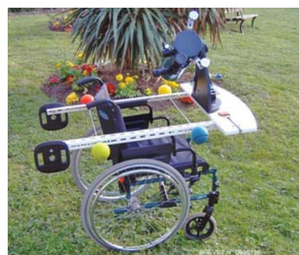
Fig. 4 et 5 : deux prototypes permettant l'observation à partir d'un fauteuil roulant, développés par l'association Des étoiles pour tous. (Jean-François Soulier)
